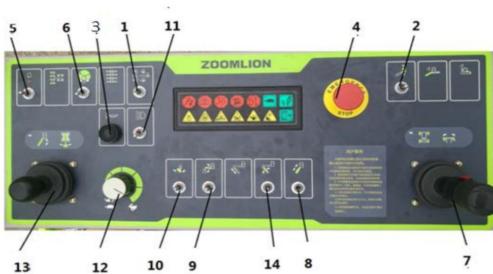
Figura 2-12 Panoul de control al platformei (este identificat doar numărul comutatorului corespunzător funcției existente)
